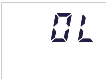
Figure 2.7: Detector Overload Alarm (Display Will Flash)
